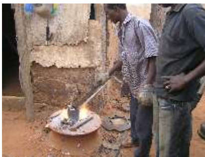
De slijpstenen van GG met te groot gat worden volgegoten met lood. Lood bron zijn oude accu polen.
