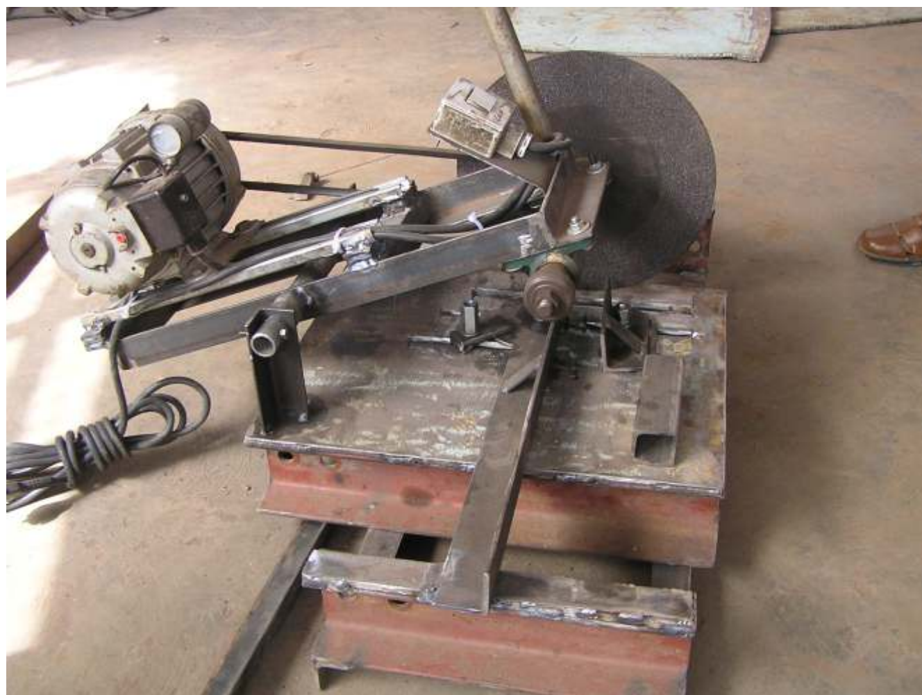
Afkort slijpmachine gemaakt met behulp van een zaag as en electromotor.
